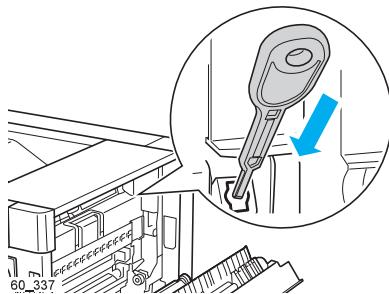
3. 紙送りレバーを上下に動かして、定着内部の用紙を移動します。
