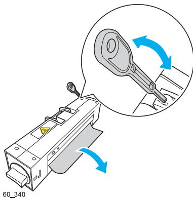
5. 紙送りレバーを矢印の方向に動かして定着内部の用紙が引き出せる場所まで移動して、下向きに引き抜きます。
